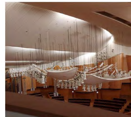
空中に浮かぶ音響反射板 ステージから発した音をホール全体に
