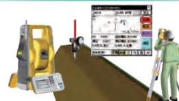
自動的に追尾する測量機器により効率的な仕上がり(出来形)の確認ができます。
